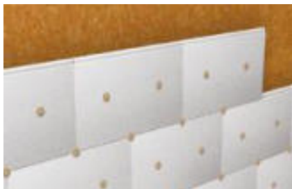
Mocowanie płyt styropianowych na płytach OSB
