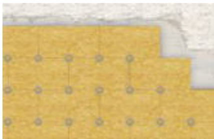
Mocowanie płyt z wełny mineralnej do podłoża betonowego
