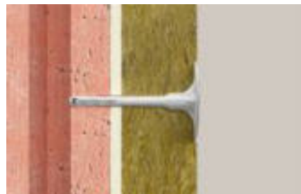
Mocowanie wełny mineralnej do muru z pustaków ceramicznych
