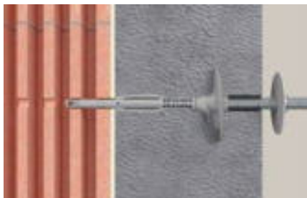
Przebieg osadzania kołka TermoZ SV II Ecotwist za pomocą osadzaka
