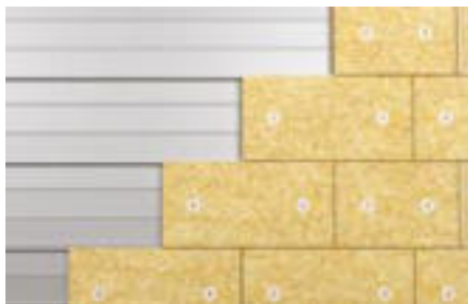
Płyty z wełny mineralnej mocowane do blachy
